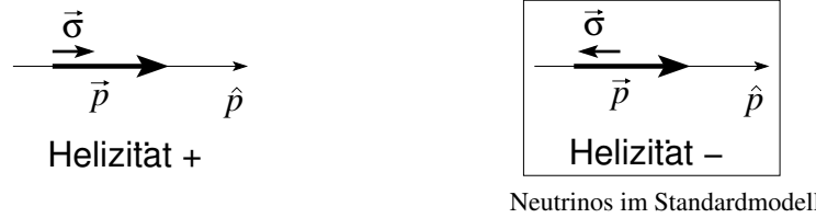
Abb. 21.1: Teilchen positiver (links) und negativer (rechts) Helizität. Letztere sind relevant im Standardmodell wo linkshändige Neutrinos und rechtshändige Anti-Neutrinos auftauchen — die Paritätssymmetrie ist gebrochen.
