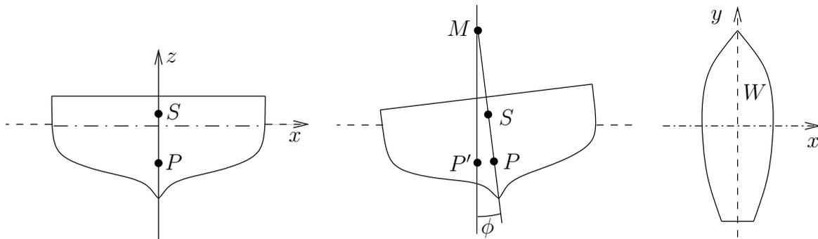
$S$ : Schwerpunkt;  $P, P'$ : geometrischer Mittelpunkt (ohne und mit Neigung) des eingetauchten Teils (Volumen  $V$ );  $M$ : 'Metazentrum';  $W$ : Schnitt des Schiffskörpers mit der Wasserebene. Die Achse  $y$  der Neigung soll eine Hauptachse von  $W$  sein:  $\int_W xy \, dx dy = 0$ . Zeige, dass die Lage von  $M$  relativ zum Schiff unabhängig von der (kleinen) Neigung  $\phi$  ist. Wie lautet nun die Stabilitätsbedingung? Zeige, dass
