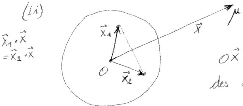
$O\vec{x}$  ist eine Symmetrie-Achse des Systems  $\Rightarrow (\vec{F}_1 + \vec{F}_2) \propto \frac{\vec{x}}{|\vec{x}|}$
